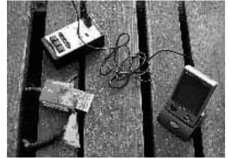
Abb. 5: Die Daten werden mit einem Pocket-PC (rechts), der an einer Dockingstation (links oben) angeschlossen ist, vom Zählgerät (links unten) herunter geladen
