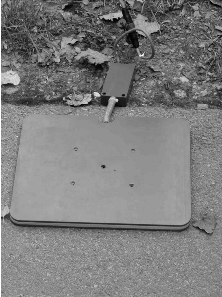
Foto 1: Slabsensor der Firma „eco-compteur“. Dieses Gerät zählt Personen aufgrund von Bodenerschütterungen (Foto: Arnberger).
